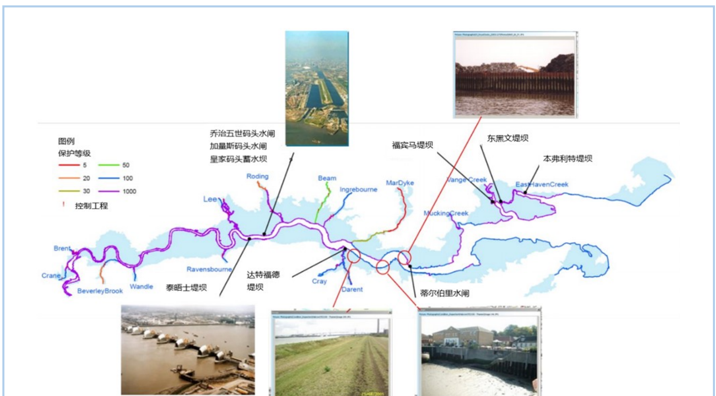
图3：受防护的泰晤士河洪泛平原、当今防护标准和主要防洪堤坝 来源：Background map，英国环境署（第三洪涝区）；开源图片
